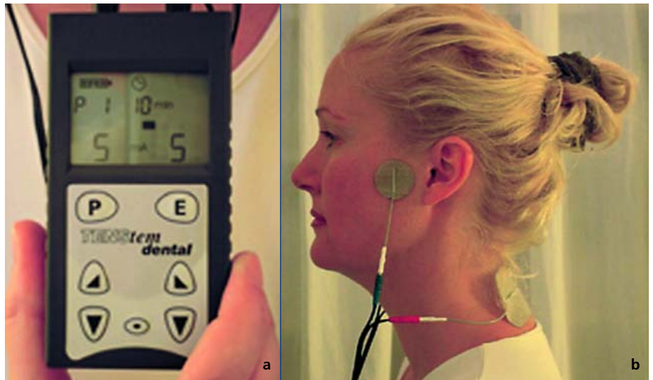
Abb. 7: a) TENSstem dental, (Fa. schwa-medico) zur Entspannung der Kaumuskulatur mittels niedrig-frequenter Stimulation. Das Gerät lässt sich auch gut zur Heimtherapie verwenden und kann bei entsprechender Indikation verschrieben werden. Die beiliegende Beschreibung ist leicht verständlich und hilfreich bei der Anlage der Elektroden (b)
